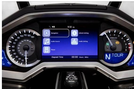
Die Anzeigen-Helligkeit passt sich automatisch an das Umgebungslicht an, nachdem der Fahrer eine von acht Beleuchtungs-Leveln vorgewählt hat. Auch der Reifendruck wird numerisch unten in der Anzeige mit angezeigt.
